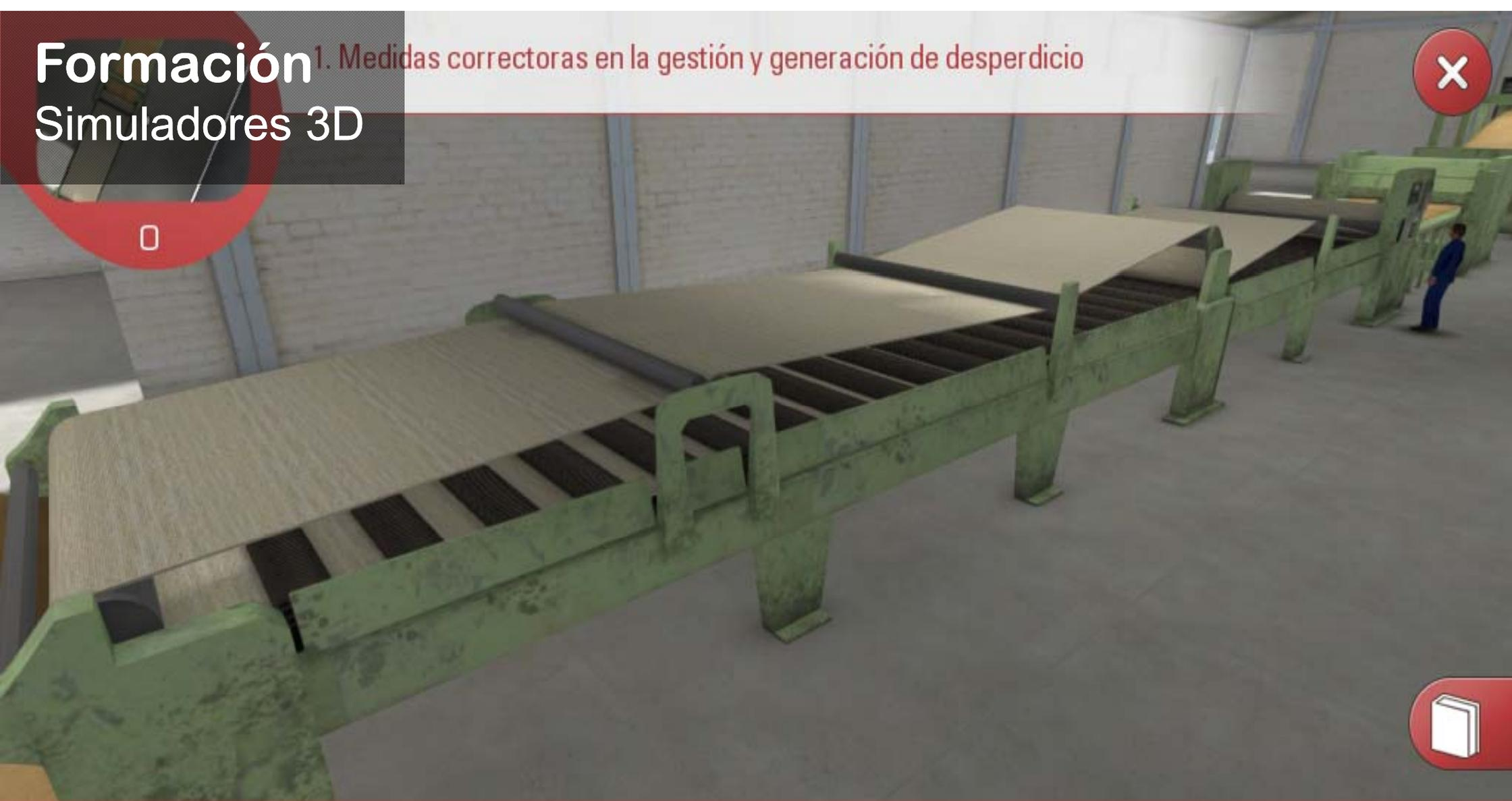
Ya sé, en el proceso de confección y encolado, la humedad y la temperatura de la mesa de secado son fundamentales, ya que si no se ajusta de forma precisa, la lámina de cartón se despegará o curvará.
